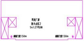
本层共设置2个疏散出口,每个疏散口宽1.50米,合计疏散宽度为3.0米。
