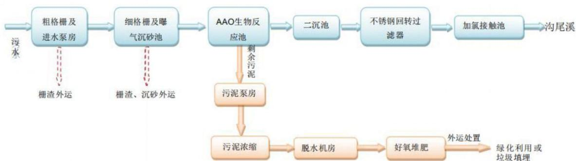
图 2 潮州市第二污水处理厂污水处理及污泥处理工艺流程图
